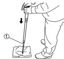
13. Das überschüssige Öl aus der Bohrung "a" im Dämpferrohr auslaufen lassen.
