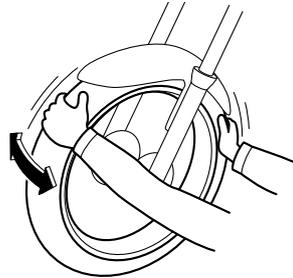
Die Vorder- und Hinterradlager müssen in den empfohlenen Abständen gemäß Wartungs- und Schmier­tabelle geprüft werden. Falls ein Radlager zu viel Spiel aufweist oder das Rad nicht leichtgängig dreht, die Radlager von einer Yamaha-Fachwerkstatt überprüfen lassen.
