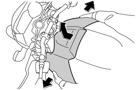
4. Den Kraftstofftank an beiden Seiten losschrauben.
