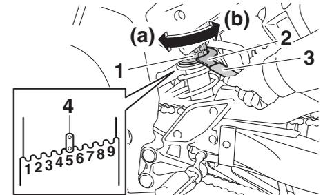
1. Einstellring der Federvorspannung
