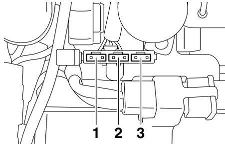
1. Linke Kühlerlüftermotorsicherung
