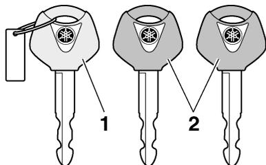
1. Schlüssel für die Re-Registrierung des Codes (rote Ummantelung)
