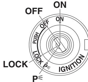
Das Zünd-/Lenkschloss verriegelt und entriegelt den Lenker und schaltet die Zündung sowie die Stromversorgung der anderen elektrischen Systeme ein und aus. Die einzelnen Schlüsselstellungen sind nachfolgend beschrieben.
