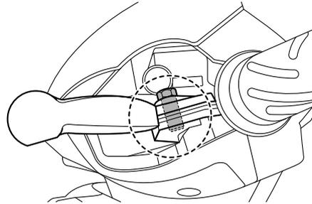
Die Drehpunkte des Vorderrad- und Hinterrad-Bremshebels sollten in den empfohlenen Abständen in einer Yamaha-Fachwerkstatt gemäß Wartungs- und Schmier­tabelle geschmiert werden.
