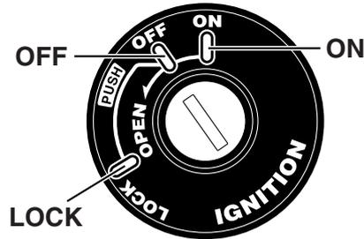
Das Zünd-/Lenkschloss verriegelt und entriegelt den Lenker und schaltet die Zündung sowie die Stromversorgung der anderen elektrischen Systeme ein und aus. Die einzelnen Schlüsselstellungen sind nachfolgend beschrieben.
