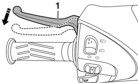
1. Handbremshebel (Hinterradbremse)
