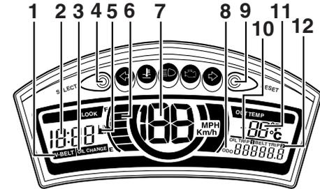
1. Anzeige für den Keilriemenwechsel “V-BELT”
