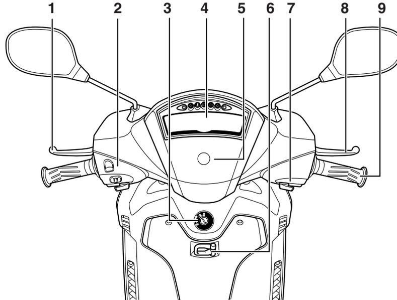
1. Handbremshebel (Hinterradbremse) (Seite 3-8)
