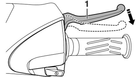
1. Handbremshebel (Vorderradbremse)
