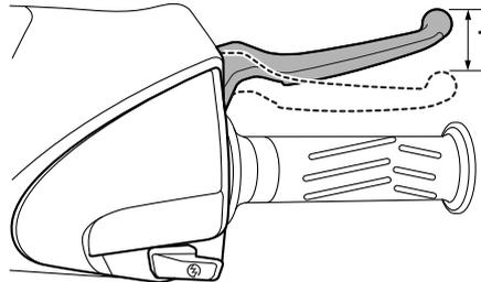
1. Spiel des Handbremshebels (Vorderradbremse)
