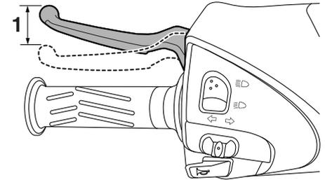
1. Spiel des Handbremshebels (Hinterradbremse)
