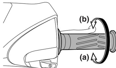
Die Fahrgeschwindigkeit wird durch Gasgeben und Gaswegnehmen angepasst. Zum Beschleunigen den Gasdrehgriff in Richtung (a) drehen. Zum Gaswegnehmen den Gasdrehgriff in Richtung (b) drehen.
