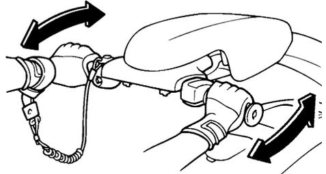
Den Lenker so weit wie möglich nach rechts und links drehen um sicherzustellen, dass sich die Jetdüse mit den Lenkerdrehungen bewegt und dass es keinen Unterschied zwischen den Volleinschlägen der Jetdüse rechts und links gibt.
