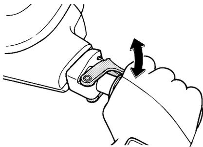
Sicherstellen, dass das Gashebelspiel der Vorgabe entspricht, wenn der Gashebel in der Leerlaufstellung steht.
