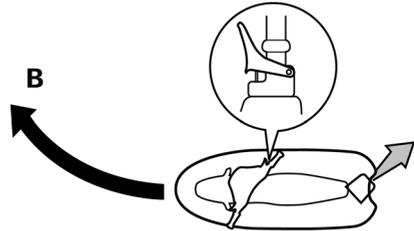
C. Wird das Gas vollständig weggenommen, liegt nur minimaler Schub vor. Bei Geschwindigkeiten über dem Langsamstlauf nimmt die Lenkbarkeit ohne Gasgeben rapide ab. Zwar ist das Wasserfahrzeug unmittelbar nach Loslassen des Gashebels noch wendbar, aber bei fallender Motordrehzahl vermag der Lenker das Wasserfahrzeug nicht mehr zu wenden, bis wieder Gas gegeben wird oder der Langsamstlauf erreicht worden ist.
