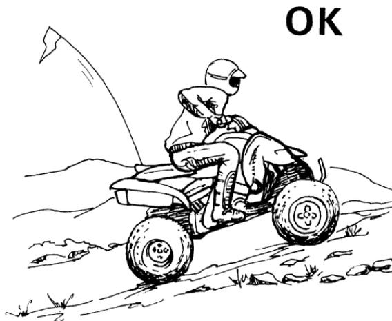
Si está subiendo una pendiente y descubre que no ha calculado correctamente su destreza para llegar a la cima, gire en redondo con el ATV mientras tenga tracción hacia delante (y espacio suficiente para hacerlo) y empiece a descender.
