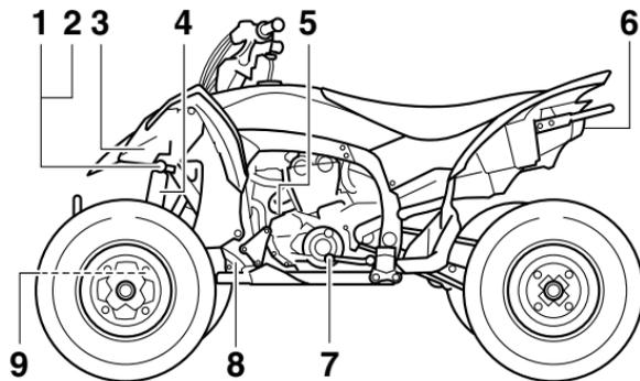
1. Perno de ajuste de la compresión del conjunto amortiguador delantero (para compresión rápida)
