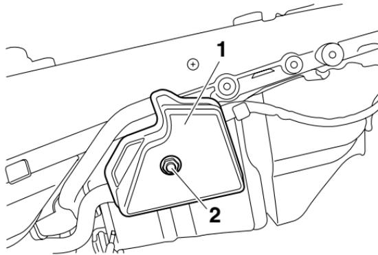
1. Cámara de fuga de gases
