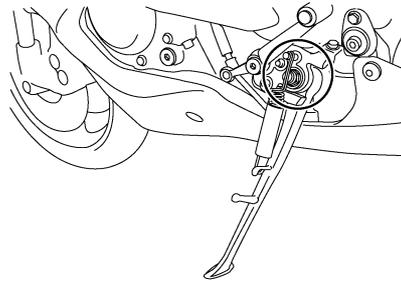
Die Funktion des Seitenständers sollte vor jeder Fahrt geprüft werden und die Drehpunkte und Metall-auf-Metall-Kontaktflächen sollten gegebenenfalls geschmiert werden.
