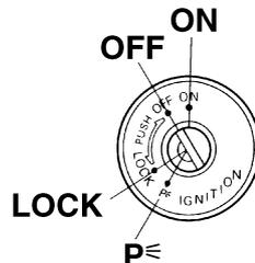
Das Zünd-/Lenkschloss verriegelt und entriegelt den Lenker und schaltet die Zündung sowie die Stromversorgung der anderen elektrischen Systeme ein und aus.
