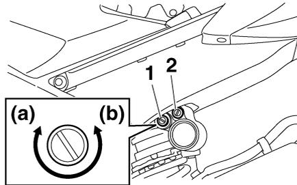
1. Druckstufendämpfungs-Einstellschraube (für schnelle Dämpfung)
