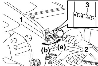
1. Einstellung der Federvorspannung
