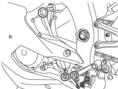
Vor Fahrtantritt die Funktion der Fußbrems- und Schalthebel prüfen und ggf. die Drehpunkte schmieren.
