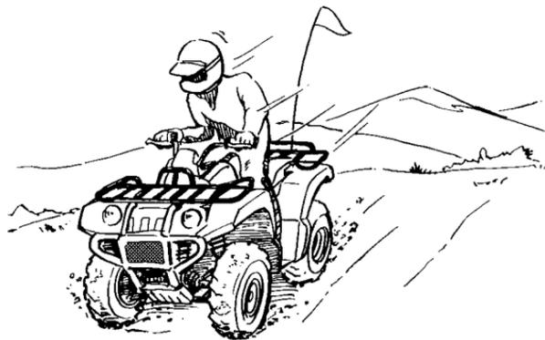
Si les roues arrière commencent à déraiper, il est possible de regagner le contrôle du véhicule (si l'espace disponible est suffisant) en manœuvrant dans la direction du dérapage. Il est déconseillé de freiner ou d'accélérer avant d'avoir repris le contrôle du véhicule.
