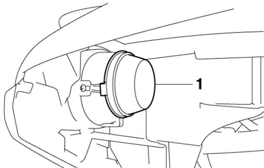
1. Cubierta de la parte posterior del faro
