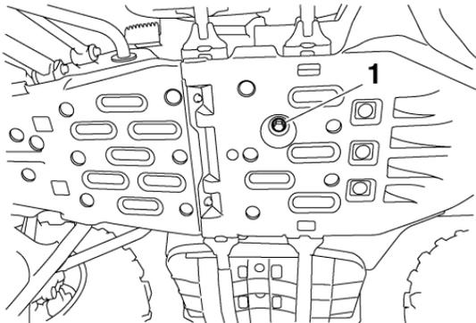
1. Perno de drenaje del aceite del motor
