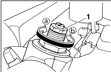
1. Einstellschraube (Federvorspannung)
