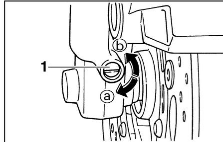
1. Einstellschraube (Druckstufen-Dämpfungskraft)
