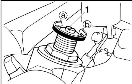
1. Einstellschraube (Zugstufen-Dämpfungskraft)
