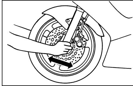
2. Die unteren Enden der Teleskopgabel greifen und versuchen, sie in Fahrtrichtung hin und her zu bewegen. Ist dabei Spiel spürbar, die Lenkung von einem YAMAHA-Händler überprüfen und instand setzen lassen.
