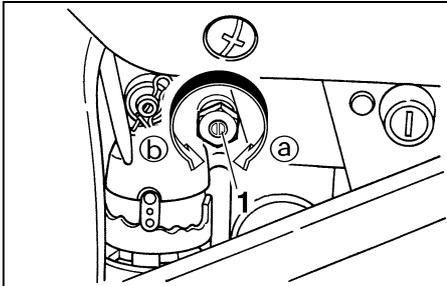
1. Einstellschraube (Druckstufen-Dämpfungskraft)
