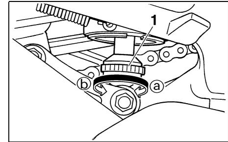
1. Einstellknopf (Zugstufen-Dämpfungskraft)
