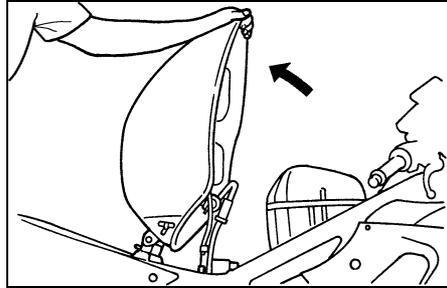
4. Den Kraftstofftank an der Vorderseite anheben, um Zugang zum Luftfiltergehäuse zu verschaffen, und dann den Tank wie in der Abbildung gezeigt abstützen.
