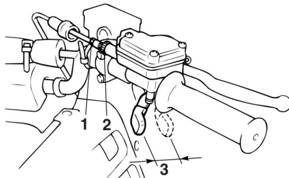
1. Vis de réglage de la garde du levier des gaz
