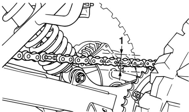
1. Tension de la chaîne de transmission
