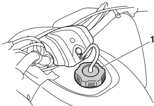
1. Bouchon du réservoir de carburant
