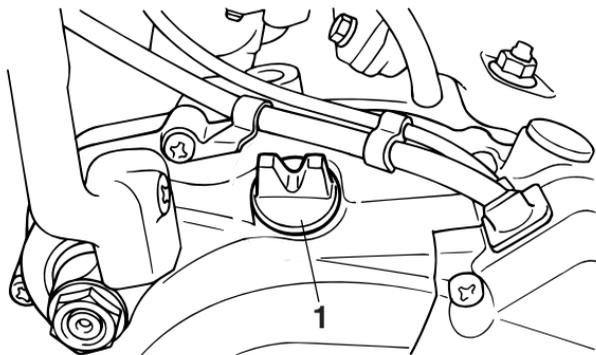
1. Bouchon de remplissage de l'huile de boîte de vitesses
