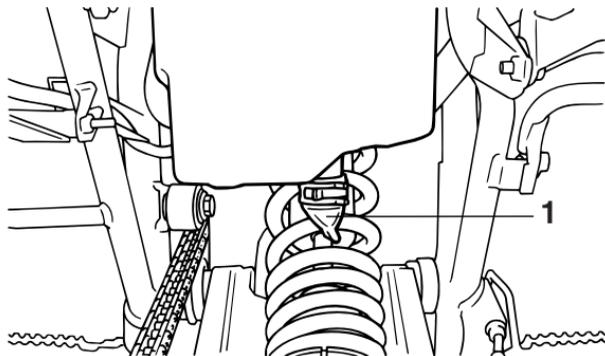
**8** 1. Tube de vidange du boîtier de filtre à air
