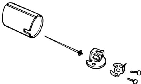
8. Déposer la cuve à niveau constant après avoir retiré ses vis.
