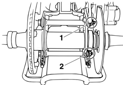
1. Écrou de fixation d'essieu (haut)
