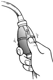
4. Öffnen Sie den Gashebel etwas, ohne mit dem Gashebelgriff, dem Neutral-Gashebel oder dem Standgashebel umzuschalten. Es ist erforderlich, dass die Gashebelöffnung abhängig von der Motortemperatur etwas geändert wird. Schieben Sie den Gashebel nach dem Start des Motors wieder in seine Grundposition zurück.
