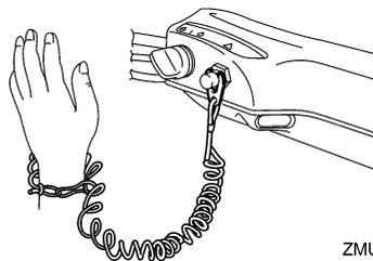
4. Bereiten Sie den Motor für das Starten vor. Weitere Informationen finden Sie auf Seite 39. Stellen Sie sicher, dass der Motor auf Neutral gestellt und die Taljeerep-Arretierungsplatte am Motor-Stoppsschalter angebracht ist. Der Hauptschalter muss auf "ON" (Ein) stehen.
