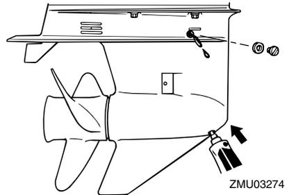
6. Setzen Sie eine neue Dichtung auf die Ölstandsschraube. Setzen Sie die Ölstandsschraube ein und ziehen Sie sie fest, wenn das Öl aus der Ölstandsschraube zu fließen beginnt.
