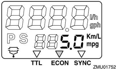
Wenn an Ihrem Boot zwei Motoren verwendet werden, zeigt das Messgerät nur den gesamten Kraftstoffverbrauch beider Motoren an.
