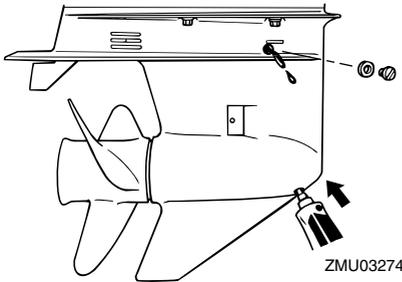
6. Setzen Sie eine neue Dichtung auf die Ölstands-schraube. Setzen Sie die Ölstands-schraube ein und ziehen Sie sie fest, wenn das Öl aus der Öffnung der Ölstands-schraube zu fließen beginnt.
