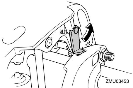
4. Modelle, die mit einer Trimmstange ausgestattet sind: Nachdem der Außenbordmotor mit dem Ankipprungshebel arretiert ist, drücken Sie den PTT-Schalter nach "DN" (Herab), um die Trimmstange zurück zu ziehen. **ACHTUNG: Beim Festmachen müssen die Trimmstangen unbedingt vollständig eingezogen sein. So werden die Stangen vor Algen- und Muschelbewuchs sowie vor Korrosion geschützt, die Schäden am PTT-Mechanismus verursachen könnten.**
