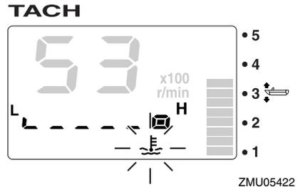
Halten Sie den Motor sofort an, wenn der Warnsummer ertönt und die Öldruck-Warnleuchte blinkt. Überprüfen Sie die Motorölmenge und füllen Sie, wenn nötig, Öl nach. Wenden Sie sich an Ihren Yamaha-Händler, wenn die Warnleuchte blinkt obwohl die notwendige Motorölmenge vorhanden ist.
