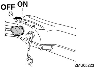
dem die Reißleine gezogen und die Sperrgabel vom Motor-Quickstoppschalter entfernt wird. Drehen Sie anschließend den Hauptschalter auf "OFF" (Aus).
