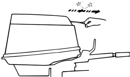
6. Schieben Sie den Handstartergriff nach dem Start des Motors langsam in seine Grundposition zurück, bevor Sie ihn loslassen.
