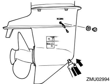
6. Setzen Sie eine neue Dichtung auf die Ölstandsschraube. Setzen Sie die Ölstandsschraube ein und ziehen Sie sie fest, wenn das Öl aus der Ölstandsschraube zu fließen beginnt.
