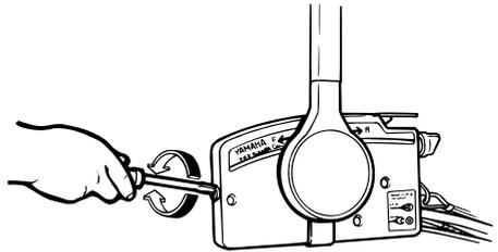
Wenn Sie eine konstante Geschwindigkeit wünschen, ziehen Sie bitte die Einstellung am Gashebel fest, um so die gewünschte Einstellung des Gashebels beizubehalten.
