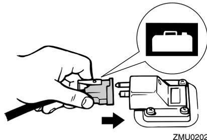
3. Wenn Ihr Außenbordmotor mit einer Lenkwiderstands-Einstellvorrichtung ausgestattet ist, schließen Sie die Kraftstoffleitung bitte sicher an der Kraftstoffleitungsklemme an.
