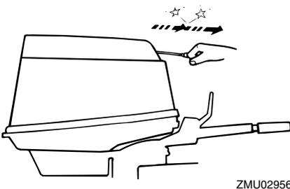
6. Schieben Sie den Handstartergriff nach dem Starten des Motors langsam in seine Grundposition zurück, bevor Sie ihn loslassen.
