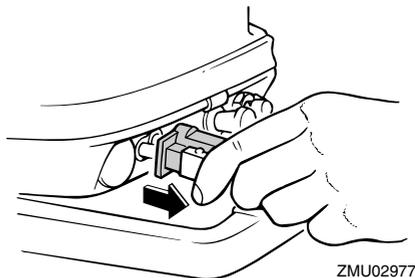
3. Platzieren Sie den Kippsperrhebel (falls vorhanden) in der geöffneten Position.
