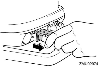
3. Ziehen Sie die Entlüftungsschraube an der Verschlusskappe des Kraftstofftanks fest (falls damit ausgestattet).
