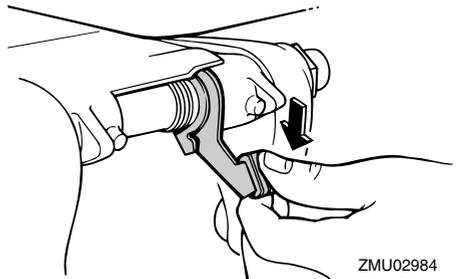
3. Kippen Sie den Außenbordmotor etwas nach oben und ziehen Sie den Flachwasserbetrieb-Auslösehebel gegen den Spiegel.
