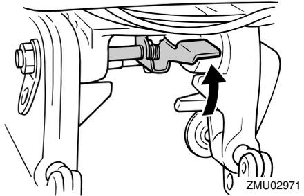
2. Bei Modellen, die mit einem Kippsperrhebel ausgestattet sind, überprüfen Sie, dass sich dieser in der Arretier-Abwärtsstellung befindet.
