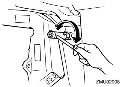
Drehen Sie die Einstellung im Uhrzeigersinn, um den Widerstand zu erhöhen.
