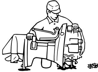
3. Lassen Sie den Kraftstoff aus dem Vergaser, dem Kraftstofffilter und der Kraftstoffleitung ab.
