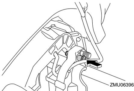
4. Modelle, die mit einer Trimmstange ausgestattet sind: Nachdem der Außenbordmotor mit dem Ankippr-Arretierhebels arretiert ist, drücken Sie den PTT-Schalter nach "DN" (Herab), um die Trimmstange zurück zu ziehen. **ACHTUNG:** Beim Festmachen müssen die Trimmstangen unbedingt vollständig eingezogen sein. So werden die Stangen vor Algen- und Muschelbewuchs sowie vor Korrosion geschützt, die Schäden am PTT-Mechanismus verursachen könnten.
