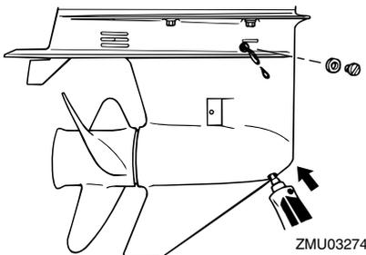
6. Setzen Sie eine neue Dichtung auf die Ölstandschaube. Setzen Sie die Ölstandschaube ein und ziehen Sie sie
