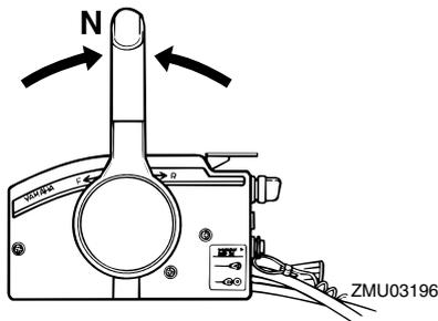
2. Drücken Sie den PTT-Schalter "UP" (Hoch), bis der Außenbordmotor vollständig nach oben gekippt ist.
