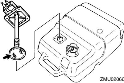
4. Reinigen Sie den Filter (er befindet sich am Ende des Ansaugrohrs) mit einer passenden Reinigungslösung. Lassen Sie den Filter trocknen.
