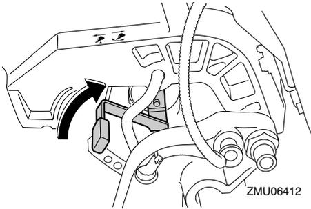
2. Halten Sie mit einer Hand die Rückseite der Motorhaube, kippen Sie den Motor etwas nach oben und ziehen Sie den Ankipp-Arretierknopf heraus, oder schieben Sie den Ankipp-Arretierungshebel wieder zurück.
