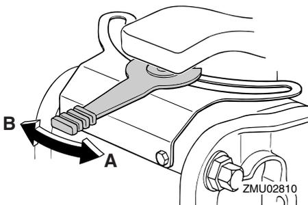
Falls sich der Widerstand selbst beim Drehen des Hebels in Richtung Port "A" nicht erhöht, stellen Sie bitte sicher, dass die Mutter
