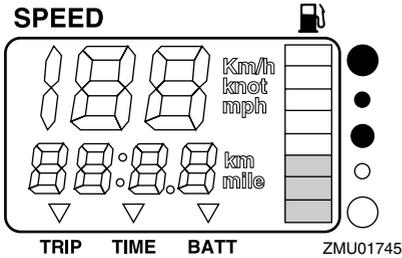
Die Anzeige des Kraftstofffüllstands kann, verursacht durch die Position des Sensors im Kraftstofftank und durch die Bootslage im Wasser, ungenau sein. Der Betrieb mit hoch getrimmtem Bug oder ständiges Wenden kann falsche Anzeigen ergeben.
