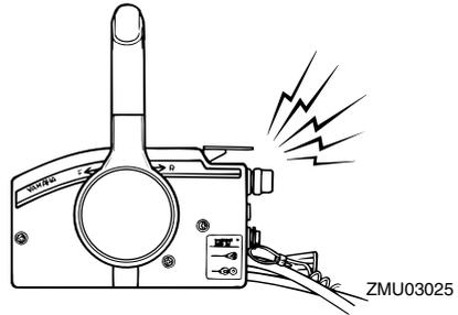
Wenn das Warnsystem aktiviert wird, schalten Sie den Motor aus und prüfen die Kühlwassereinlässe:
