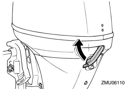
Nach dem Einbau Motorhaube auf festen Sitz überprüfen, indem man mit beiden Händen dagegen drückt. Sollte die Motorhaube locker sein, lassen Sie es von Ihrem Yamaha-Händler reparieren.
