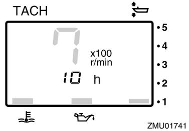
Um das Anzeigeformat zu ändern, drücken Sie die "mode" (Modus)-Taste. Die Anzeige kann die Gesamtbetriebsstunden oder die Fahrtstunden anzeigen oder ausgeschaltet werden.
