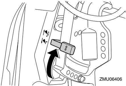
3. Kippen Sie den Außenbordmotor etwas nach oben in die gewünschte Position und schieben Sie den Kipperrhebel nach unten in die Arretierstellung.
