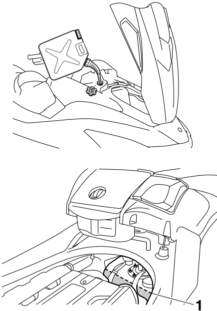
1 Ca. 50 mm (2 in) unterhalb der Oberkante des Kraftstofftanks
